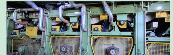
La vapeur de l'installation à copeaux est utilisée dans le processus de séchage thermique. Lorsque le papier entre dans la sécherie, il contient un taux d'humidité de 50 % et en étant conduit à travers des cylindres sécheurs chauffés à la vapeur, il ne reste que 5-8 % d'humidité lorsque le papier sort.
