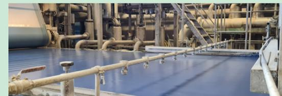
La masse arrive sur une bande perforée où elle est séchée. Il s'agit d'un processus mécanique et thermique. On peut extraire environ la moitié de l'eau à l'aide de la machine.
